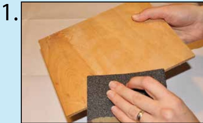
Lesene deščice po potrebi pobrusimo po robovih.
